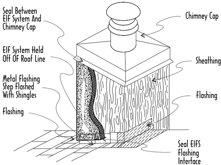
**Fig. 1 PROPER FLASHING**
